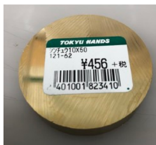
真鍮円盤(厚さ10mm 直径50mm)
