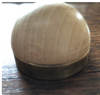
真鍮円盤と木半球を 多目的用ボンドで接着
