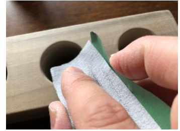
穴の縁部分を面取りする
